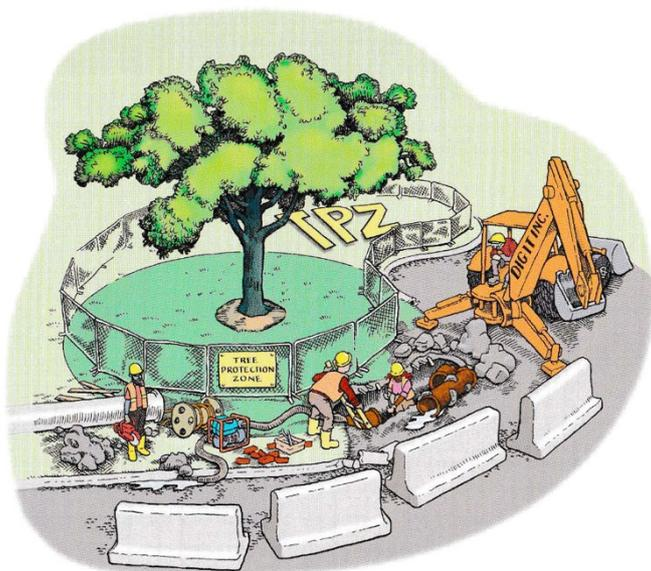
図2 樹木保護範囲の立入禁止柵設置と明示<sup>5)</sup>
